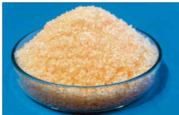
Nanogel w formie handlowej oraz po uwodnieniu
